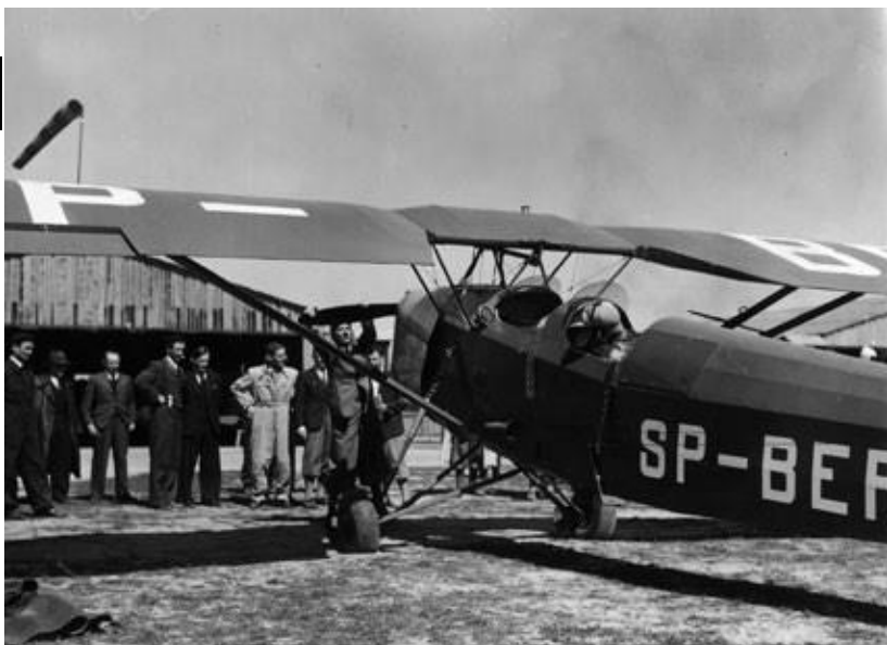
Fot. 53 Uruchamianie silnika w samolocie RWD-8. Lotnisko mokotowskie, okres przedwojenny. Źródło: NAC, domena publiczna.
