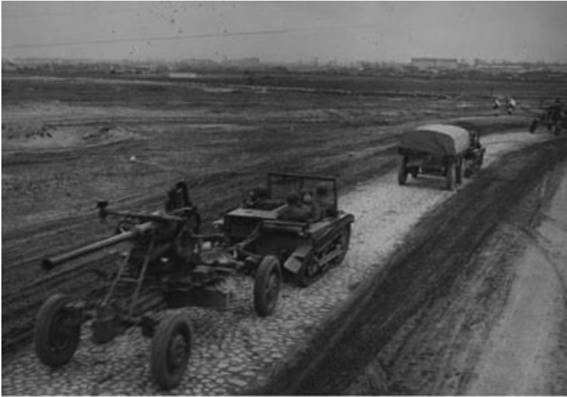
Fot. 46 Bateria artylerii przeciwlotniczej w marszu. Widoczny ciągnik C2P i działko Bofors kal. 40 mm. Źródło: NAC, domena publiczna.
